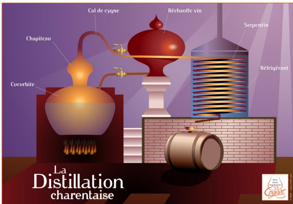
Figure 6 : Constitution d'un alambic charentais
